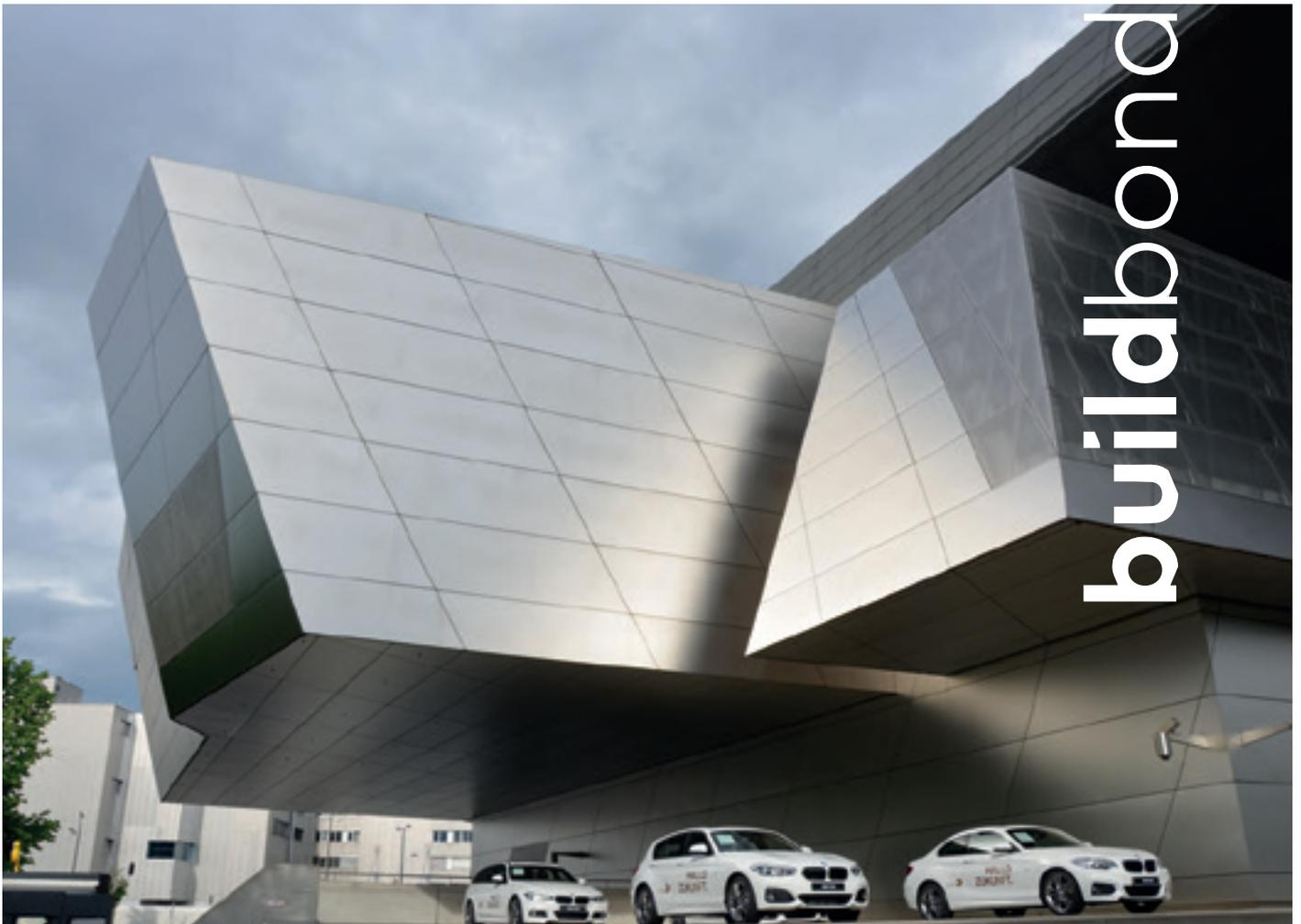
Buildbond A2 es un panel composite, constituido por dos chapas de aluminio y un núcleo mineral incombustible, de la clase "A2 - s1, d0", conforme a la norma europea EN13501-1.
